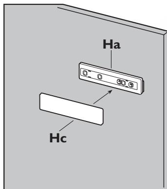
10. Откройте дверцу прибора и дверцу кухонного шкафа под углом 90°. Вставьте маленькую планку (Нб) в направляющую (На). Совместите друг с другом дверцу прибора и дверцу кухонного шкафа и наметьте отверстия.
